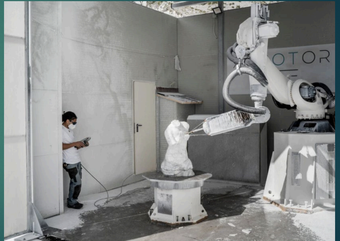
Un moderno laboratorio di scultura secondo il metodo tradizionale del puntatore e quello attuale del robot
